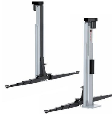
Professionelle, grundrahmenfreie Hebebühne zum Heben von Kleinwagen (z.B. Smart for two) bis hin zu Transportern (z.B. VW Crafter RS3 oder MB Sprinter mit langem Radstand von 4.325 mm) bei einer Aufstellbreite von 3.600 mm. Die extrem langen Tragarme ermöglichen das Heben an original Aufnahme Punkten.
