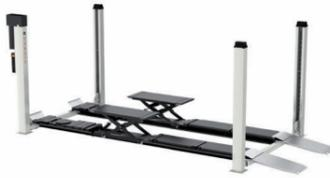
Zum Heben und für die Achsvermessung von Kraftfahrzeugen mit einem Gesamtgewicht bis 4.500 kg. Durch lange Fahrschienen auch für große Fahrzeuge mit langem Radstand geeignet. Beidseitig ausziehbarer Radfreiheber bis 3.500 kg. Fahrschienen 500 x 5.500 mm.
